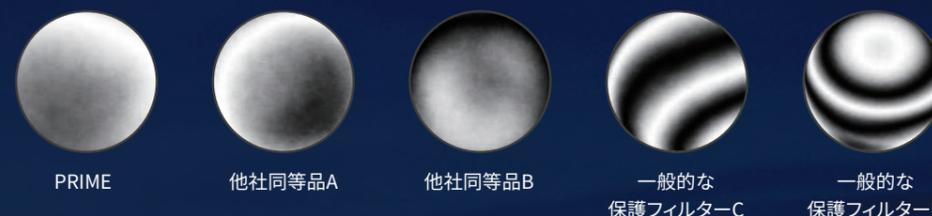
一般的にフィルターガラスの平面度はレンズの解像力に影響を及ぼしますので、レベルの高い平面度を維持することが課題です。上図は、フィルター枠に取り付けた状態の各種保護フィルターの透過面精度を測定したのですが、平面度が低いフィルターには「ニュートンリング」という縞模様がはっきりと見られます。
